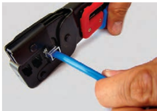
شکل ۲۹- پرس کردن سوکت RJ45
