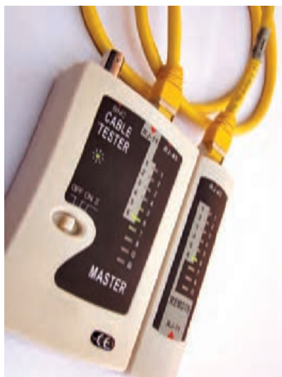
شکل ۲۰- تست کابل شبکه
